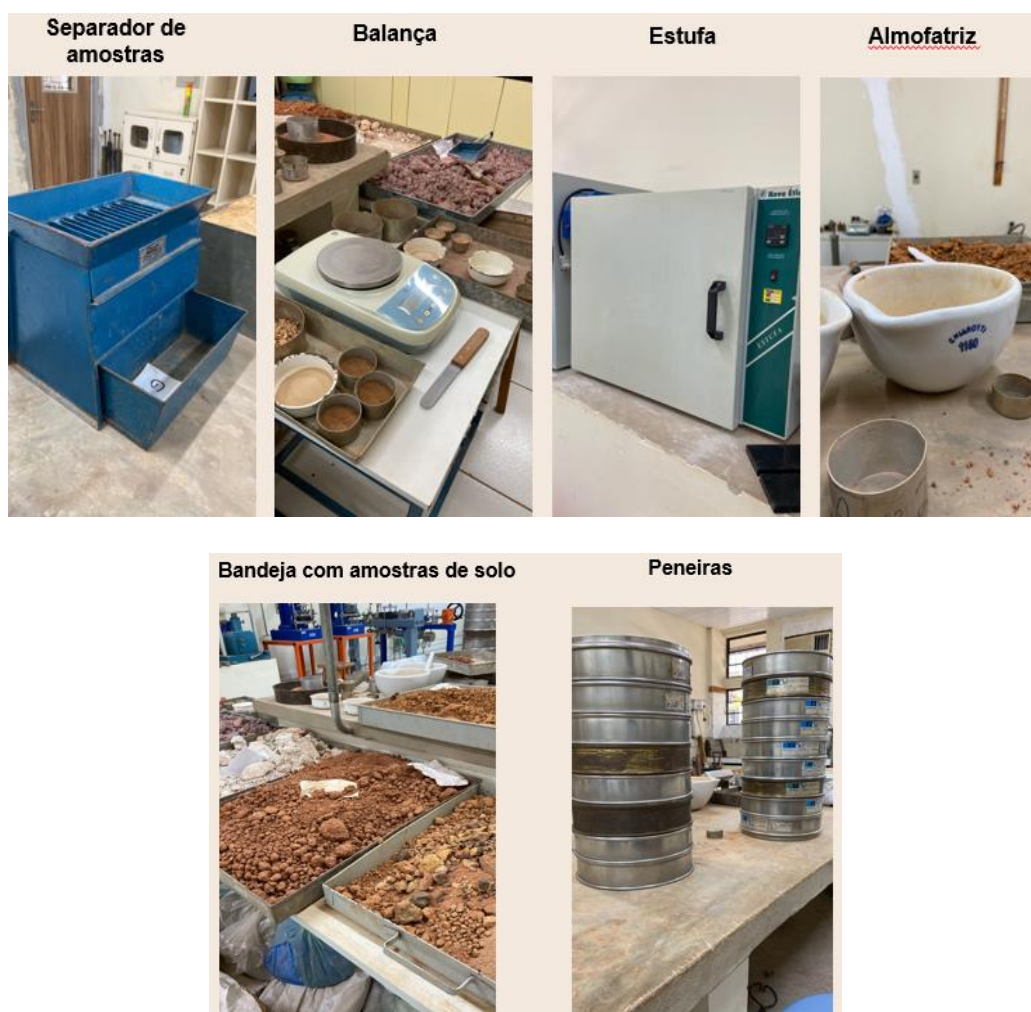
Figura 6 – Etapas do procedimento de Estudo granulométrico de solos
