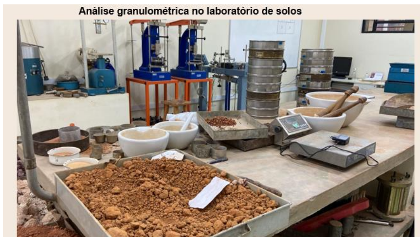
Figura 6 – Etapas do procedimento de Estudo granulométrico de solos
